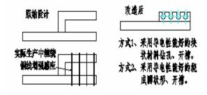
应到,断线后不刹车停机。为有效感应断线头,生产中员工有时会用铜线扎几个圈的形式进行,部分提供给客户的品质改善措施中也有提到此改善方案。
